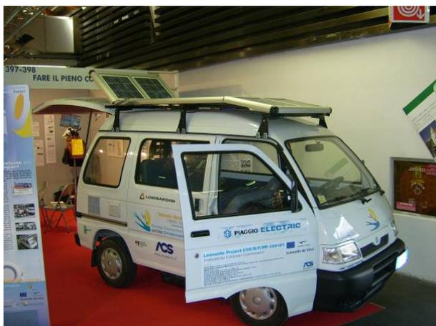
Fig. 3 - Il prototipo di veicolo ibrido solare.
