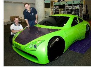
Fig. 22 - Ultra-Commuter, un veicolo ibrido solare sviluppato presso la Queensland University.
