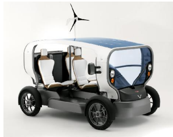
Fig. 24 - Venturi Ecletic, una city-car che utilizza energia solare ed eolica.
