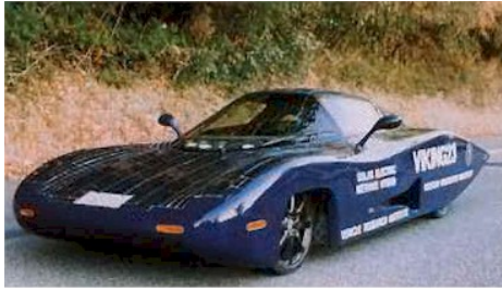
Fig. 21 - Il Viking 23, prototipo di veicolo ibrido solare costruito presso la Western Washington University nel 1994.
